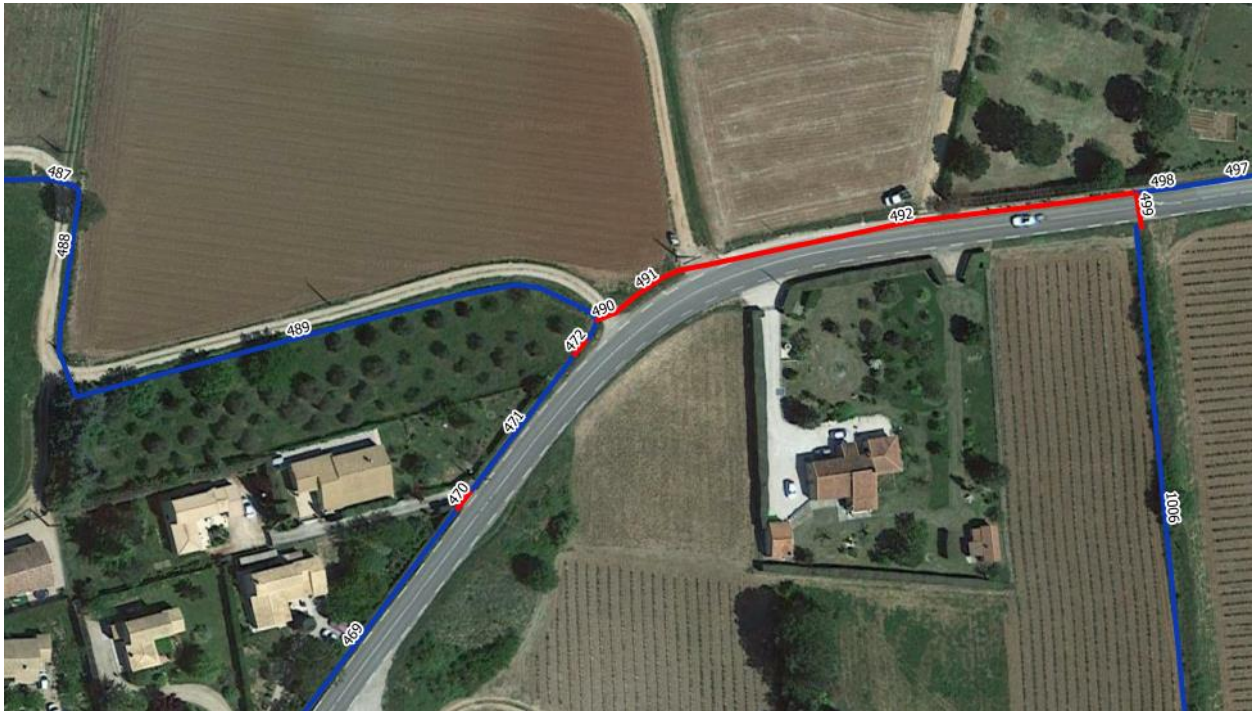
Figure 85 : Recalibrage du réseau pluvial dans le virage de la route de Correns
