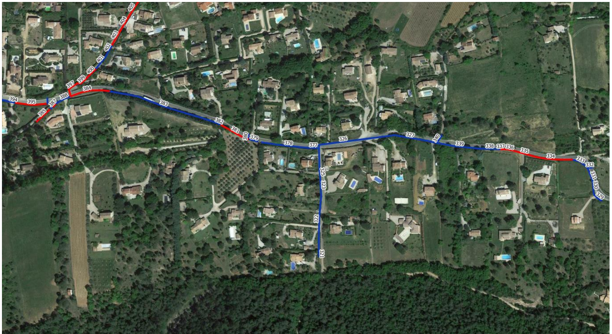
Figure 82 : Recalibrage du réseau pluvial route de Vins
