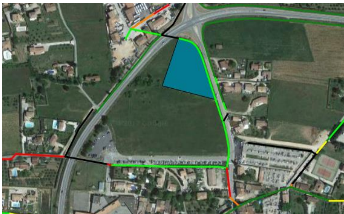
Figure 77 : Emprise bassin de rétention - configuration 2
